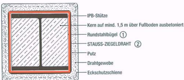
Einteilige Stahlstütze mit Ummantelung
