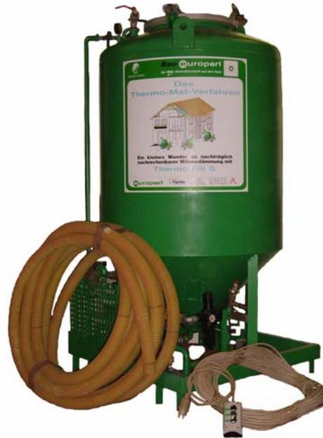
Der **Thermo-Mat 2**, ein Spezialgerät zum Verblasen von **Bau-Europerl**® ist ein seit den 70er Jahren bewährtes System. Heute steht diesem im Lauf der Jahre immer weiter entwickelten Spezialgerät ein darauf abgestimmtes wasserabweisendes **Bau-Europerl**® zur Verfügung: **Thermo-Fill**® S.
