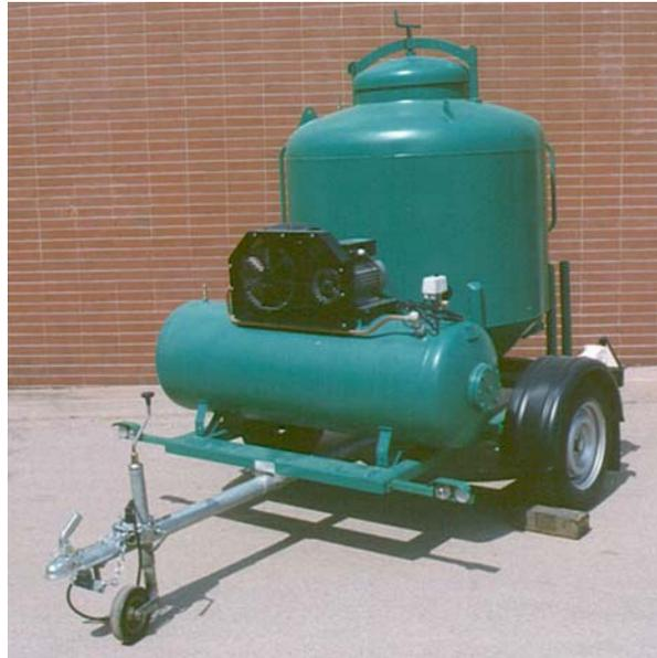
Der **Thermo-Mat**, ein Spezialgerät zum Verblasen von **Bau-Europerl** ist ein seit den 70er Jahren bewährtes System. Heute steht diesem im Lauf der Jahre immer weiter entwickelten Spezialgerät ein darauf abgestimmtes wasserabweisendes **Bau-Europerl** zur Verfügung: **Thermo-Fill S**.
