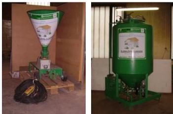
Der **Thermo-Mat**, ein Spezialgerät zum Verblasen von **Bau-europerl**<sup>®</sup>.
