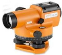
Vereinfacht das Einrichten von Baustellen, oft bereits mit Laser erhältlich. Kann auch durch Schlauchwaage ersetzt werden.
